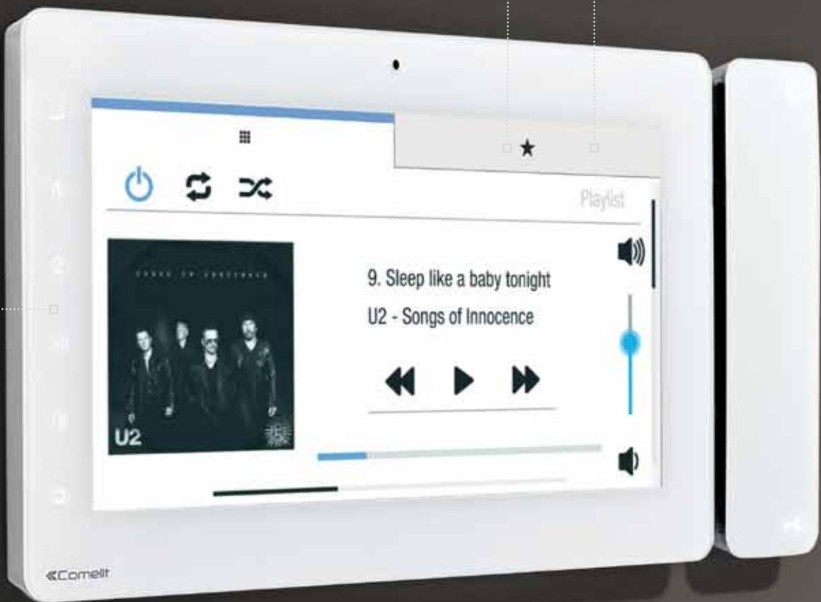
NORMALERWEISE NICHT SICHTBARE, WEISS HINTERLEUCHTETE SENSITIVE TOUCH TASTEN SIE LASSEN SICH DURCH EINFACHES WISCHEN MIT DEN FINGERN ÜBER DEN BILDSCHIRM AKTIVIEREN (SWIPE-FUNKTION).
