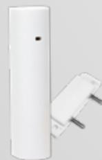
RFH20 ist ein Überschwemmungssensor, der das Vorhandensein von Wasser auf Bodenhöhe erkennt. Wird mit einer einstellbaren Sonde geliefert, die über ein 2 m langes Kabel an den Sender angeschlossen wird.
