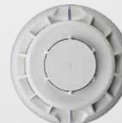
RFSMK ist ein Sensor, der Rauch- und Wärmeerkennung kombiniert. Ausgestattet mit einem Sabotageschalter, einer 360° sichtbaren LED und einer selbstkompensierten optischen Kamera ist er für H24-Raumschutz geeignet.
