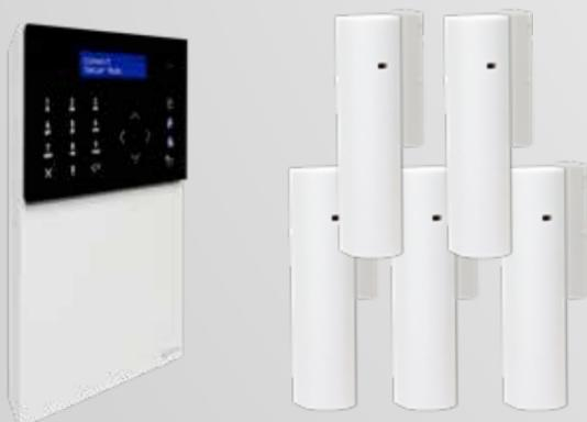
Basis-Kit der Serie SecurHub inkl. Funkzentrale HUB32LCD, 5 Stk. Funk-Magnetkontakte RF1MCW. Das Kit kann um alle weiteren SecurHub Zubehörteile auf maximal 32 Funkzonen und allgemein auf 96 Zonen (32 Funk + 64 verdrahtet) erweitert werden. Es besteht die Möglichkeit bis zu 16 WiFi Kameras (Art. WICCAMS01FA) in das System einzubinden.
