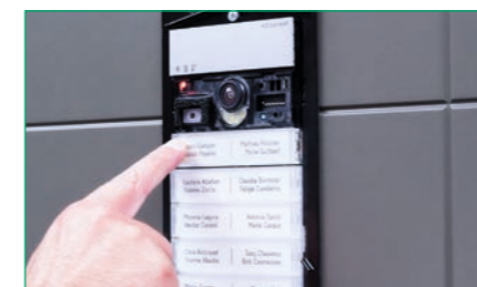
10. DRÜCKEN Sie die Taste, der die im vorherigen Punkt gewählte Adresse zugewiesen wird. Bei richtiger Zuweisung der Adresse wird ein Bestätigungston ausgegeben. Wenn Sie nacheinander die anderen Tasten AUSWÄHLEN , nehmen diese automatisch die Rufadresse mit nachfolgendem Code an
