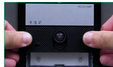
7. BEFESTIGEN Sie das Audio/Video-Modul, die Tastenmodule und die Namensschilder
