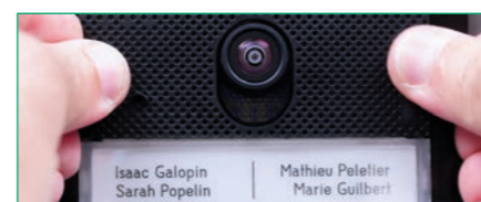
12. BEFESTIGEN Sie die Frontblende
