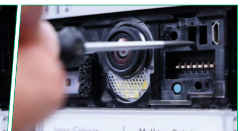
11. BRINGEN Sie den DIP-Schalter in die Ausgangskonfiguration und VERLASSEN Sie den Programmiermodus (dies wird durch das Erlöschen der LED angezeigt)
