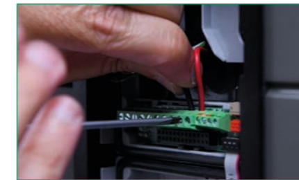
5. VERSORGEN Sie die Module und SCHLIESSEN Sie den eventuellen Türöffner an
